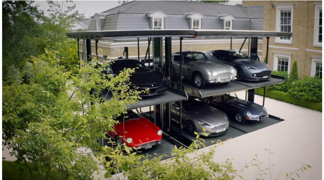
„Dieses Autoparksystem wird unsichtbar in den Boden versenkt, die waagerechten unterirdischen Plattformen sind erst beim Anheben für den Ein- oder Ausparkvorgang sichtbar.“
